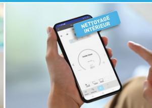
Arrêtez la thermopompe et touchez l'icône « Nettoyage intérieur » dans l'application Panasonic Comfort Cloud<sup>®</sup> pour activer le nettoyage intérieur.
